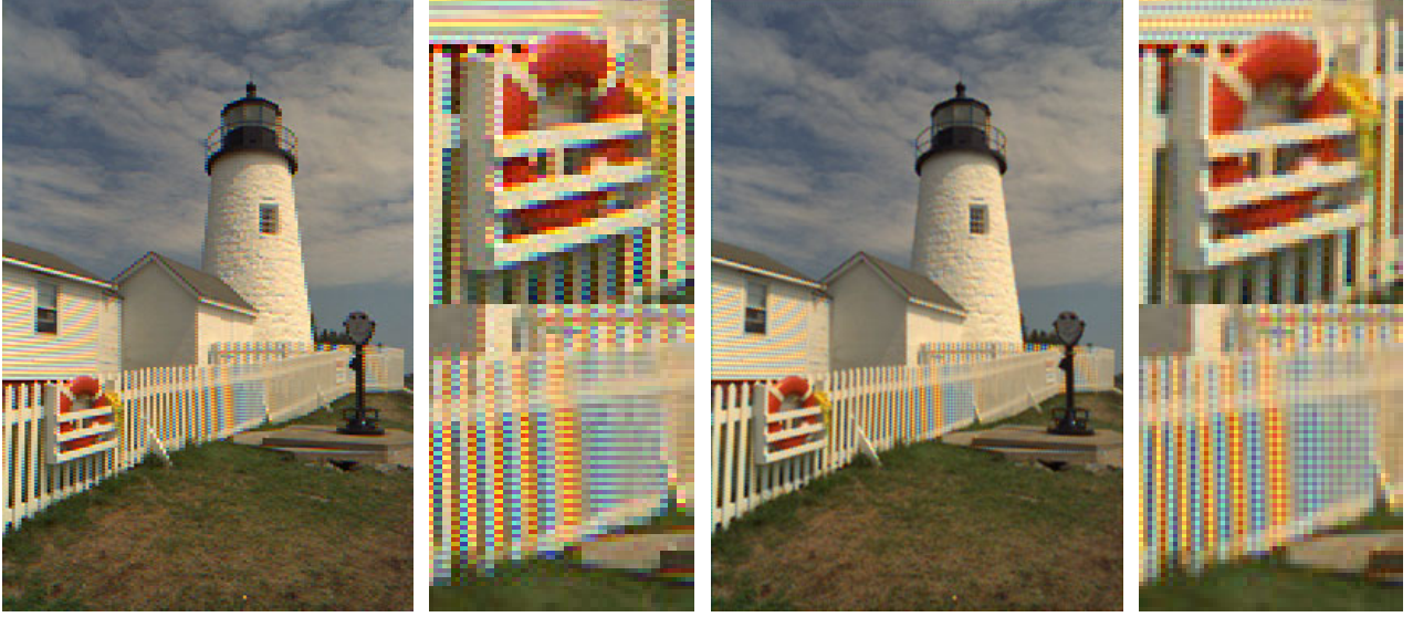
FIG. 4 – (a) Méthode d'interpolation par copie de pixels (22.85dB). (b) Par interpolation bilinéaire (25.87dB)
