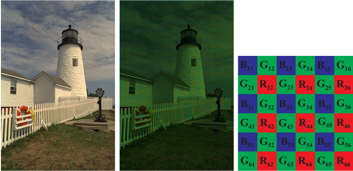
FIG. 2 – (a) Image utilisée pour la simulation. (b) Image CFA, les pixels dans les plans RGB de l’image originale sont supprimés pour simuler un échantillonnage par une matrice de Bayer. L’image apparaît verdâtre parce qu’il y a deux fois plus de pixels verts que de rouges et de bleus dans la matrice de Bayer. (c) Numérotation de la matrice de Bayer.
