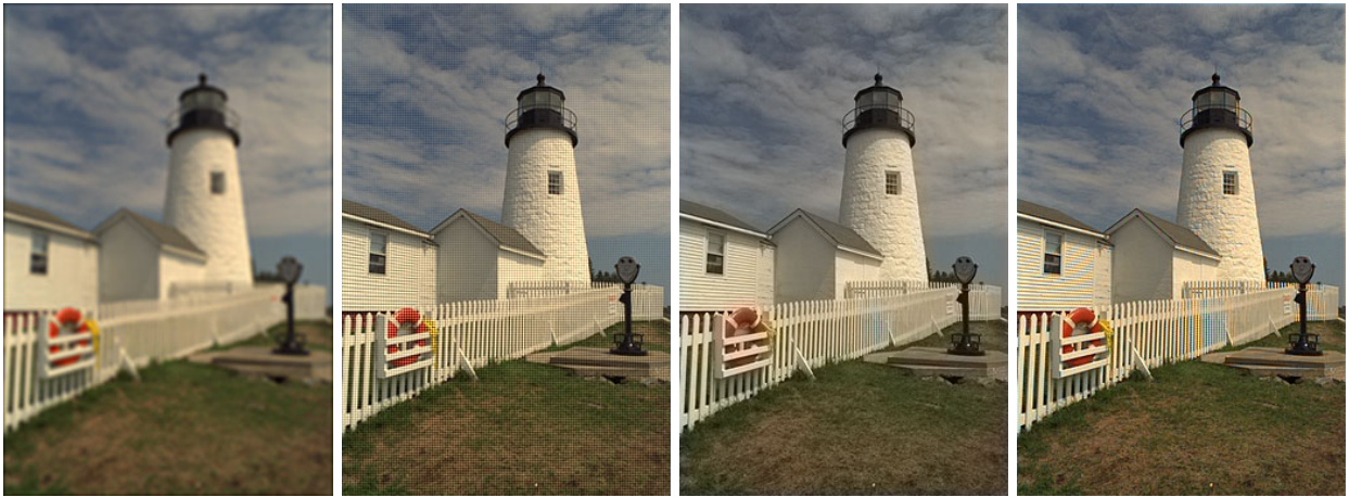
FIG. 14 – Illustration des artefacts lors de l’utilisation des algorithmes de démosaïçage. (a) Lissage excessif (b) Effet de grille (c) Couleur d’eau (d) Fausses couleurs
