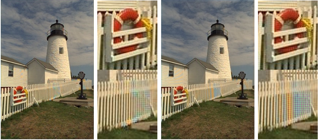
FIG. 12 – (a) Méthode de Gunturk avec une initialisation du canal vert avec la méthode de Hamilton et Adams. (36.94dB) (b) Méthode par sélection de fréquence. (34.39dB)
