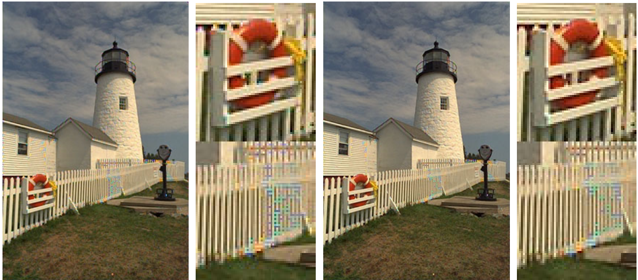
FIG. 8 – (a) Méthode d’interpolation suivant la direction du gradient proposé par Laroche et al. (31.81dB). (b) Méthode proposée par Hamilton et Adams, reconnaissance de formes par gradient vert corrigé du Laplacien de rouge ou bleu (34.20dB).
