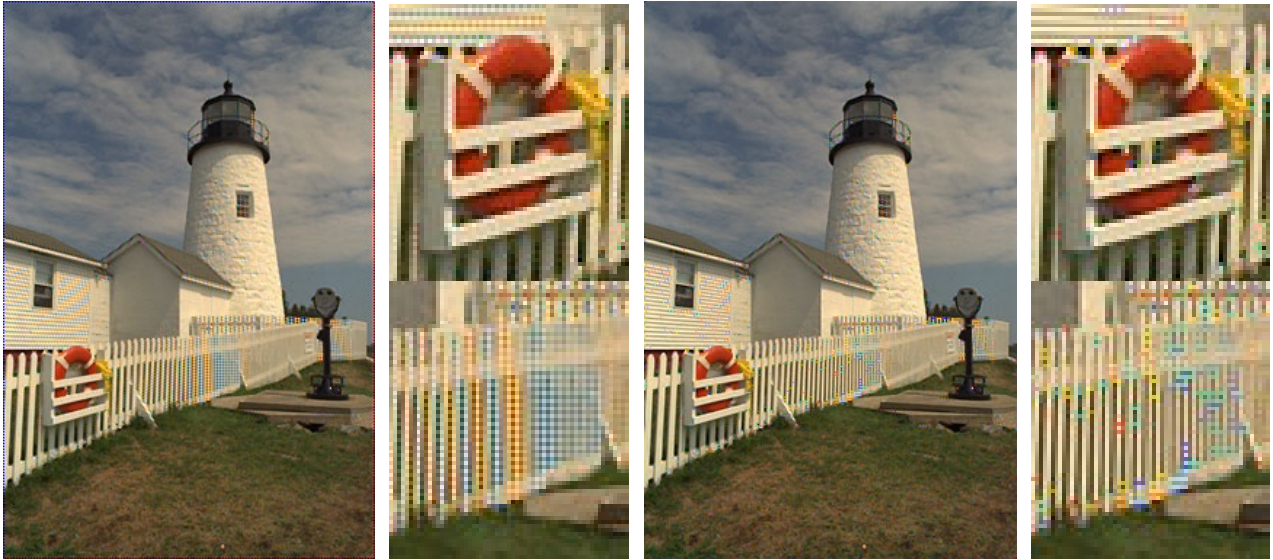
FIG. 7 – (a) Méthode de filtrage médian proposé par Freeman (30.54dB)(b) Méthode d’interpolation suivant la direction du gradient proposé par Hibbard (30.38dB).
